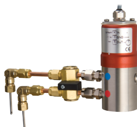
TA-LINK Датчик для точного измерения дифференциального давления. PN25, -15/80 °C Др диапазон: 0-40 кПа или 0-100 кПа Вых.: 0-10 В или 4-20 мА
