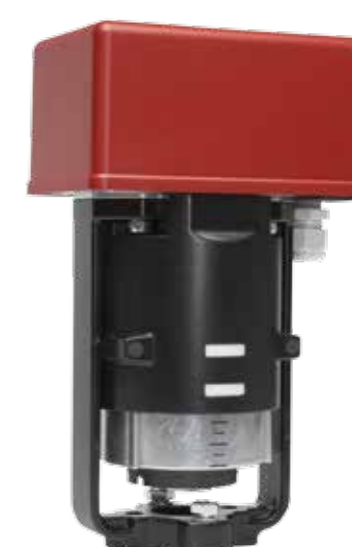
TA-MC100 FSE/FSR с возвратной пружиной FSE: Шток выдвигается при отключении питания FSR: Шток втягивается при отключении питания 24 В AC/DC пропорц. / 3-точ. 230 В AC 3-точ.
