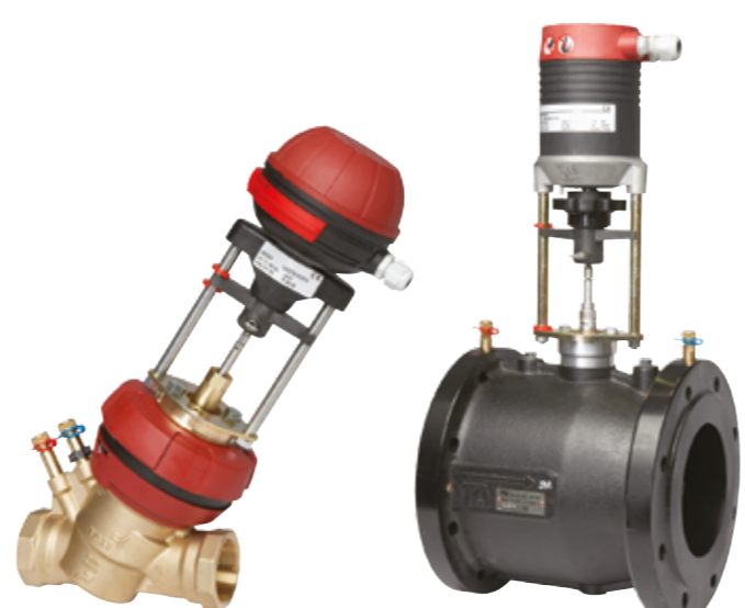
TA-FUS10N-C DN 32-150, PN16/25, -20/150 °C настраиваемый Kvs Для пропорц. /3-точ. рег. Равнопроц. (EQM)
