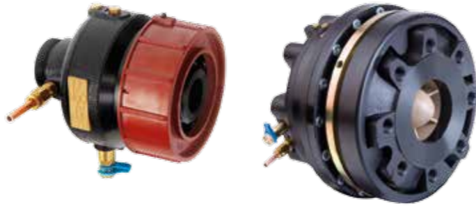
DA 516, DAF 516 DA 516: для установки на обратном трубопроводе DN 15-50, PN16/25, -10/120/150 °C Др диапазон: 5-150 кПа DAF 516: для установки на подающем трубопроводе DN 15-150, PN25, -10/150 °C Др диапазон: 5-150 кПа
