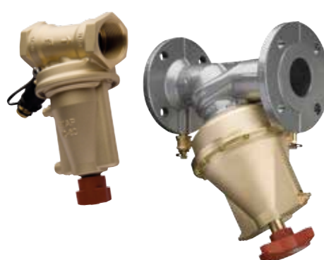
STAP DN 15-50, PN16, -20/120 °C Др диапазон: 5-80 кПа DN 65-100, PN16, -10/120 °C Др диапазон: 20-160 кПа
